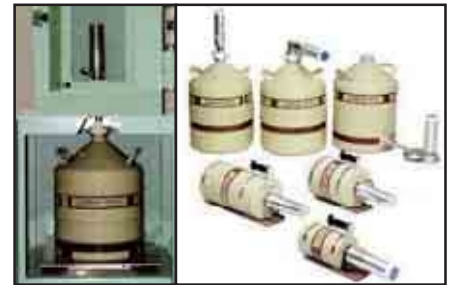
①放射性物質の有無を調べる ②空間の放射線量を調べる 半導体検出器 放射線のエネルギー分布を知るもの。放射性物質の種類を調べるのに利用します。(単位:eV)
