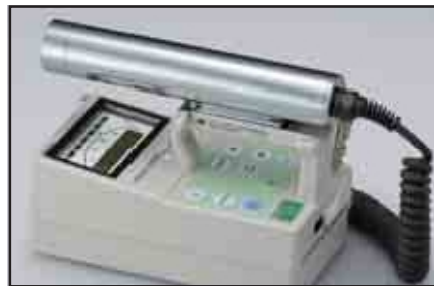
②空間の放射線量を調べる シンチレーション式サーベイメータ 空間の放射線量を知るもの。放射線による人体への影響を調べるのに利用します。(単位: \mu\text{Sv/h} )
