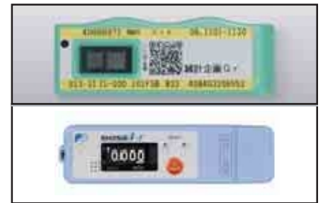
③個人の被ばく線量を調べる 個人線量計 個人が受ける放射線量を知るもの。放射線量を知りたい時にも使われます。(単位:mSv) (注)個人被ばく線量計は、携帯電話などからの電気的ノイズにより誤計数する場合がありますので、携帯電話などと同じポケットに入れて使用しないこと。
