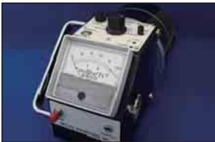
②空間の放射線量を調べる 電離箱式サーベイメータ 放射線量を知るもの。放射線によって電離させて放出されるイオンの量から放射線の量を調べます。(単位: \mu\text{Sv/h} )
