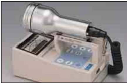
①放射性物質の有無を調べる ガイガー・ミュラー・カウンタ(GM計数管)など 放射線の数を知るもの。物質に放射性物質が付着しているかを調べるのに利用します。 (単位:cpm*など) ※cpm:1分間に計測された放射線の数
