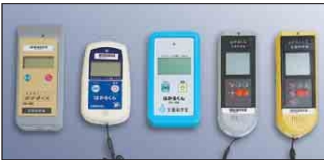
②空間の放射線量を調べる 簡易放射線測定器「はかるくん」(シンチレーション式サーベイメータ) 空間の放射線量を知るもの。身の周りの放射線(ベータ( \beta )線、ガンマ( \gamma )線)を調べることができる学習用の測定器です。(単位: \mu\text{Sv/h} )
